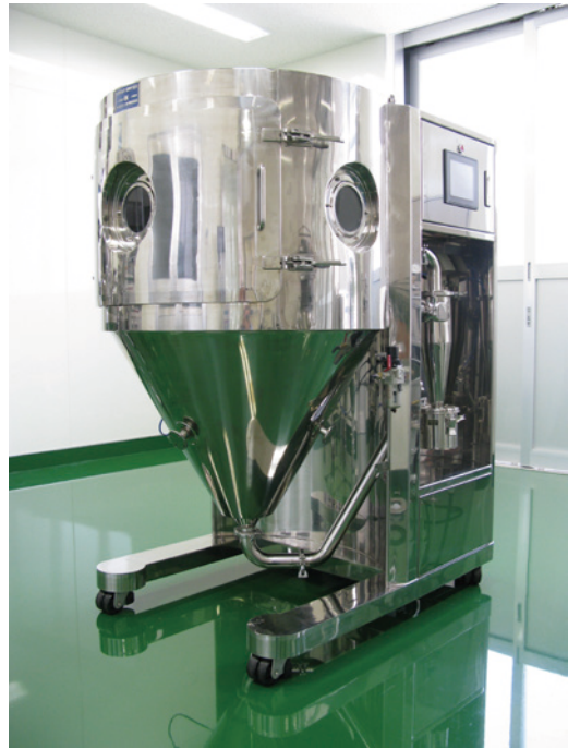
L-8i型开放式研发用离心式喷雾干燥机
