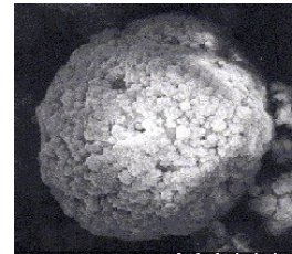
中部電力㈱製人工ゼオライトシーキュラス 電子顕微鏡画像
