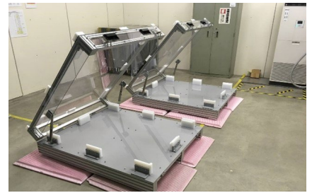
大型光罩玻璃基板搬运专用箱 (塑料材质)
