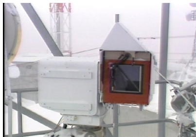
防止镜头落雪的户外相机用加热器
