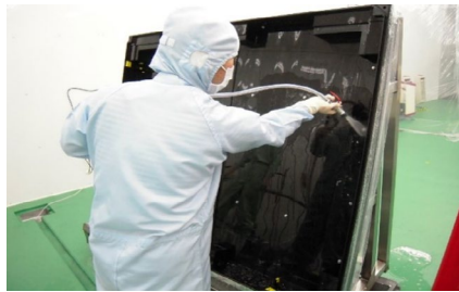
光罩板搬运专用箱清洗 (洁净室)
