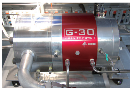
ターボ発電機
