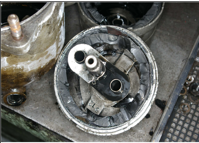
柴油机机油过滤器的油泥 <在不添加的条件下：有1cm厚度的附着物，在添加的条件下：只有过滤纸而无油泥层>
