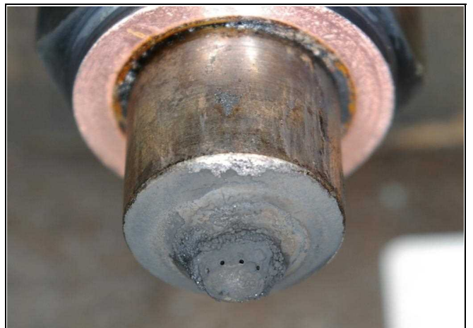
柴油机的喷嘴 <在添加的条件下能清楚地看到喷孔><不发生局部燃烧><没有不均匀燃烧>
