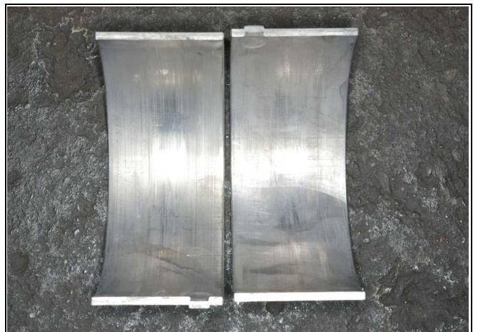
柴油机的曲轴颈原材料 <在添加的条件下，金属表面没有伤痕，也不发生镜面化和金属摩擦>
