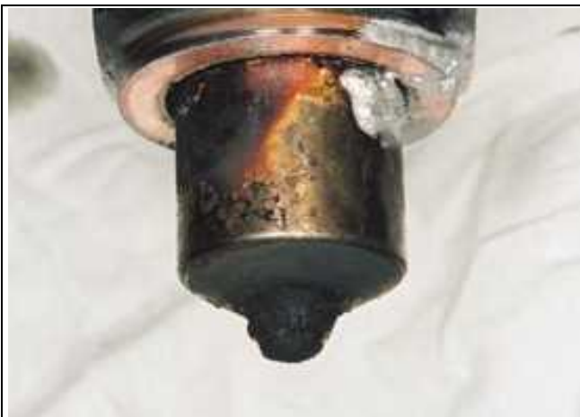
柴油机的喷嘴 <在添加的条件下能清楚地看到喷孔><不发生局部燃烧><没有不均匀燃烧>
