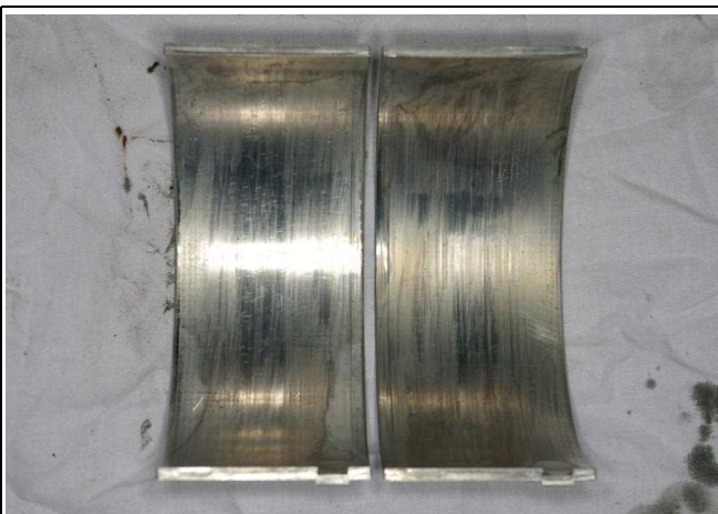
柴油机的曲轴颈原材料 <在添加的条件下，金属表面没有伤痕，也不发生镜面化和金属摩擦>
